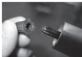
お手持ちの刈払機ギヤケースからパイプを取り外して本機と交換するだけ。回転軸(スプライン)形状と合致するアダプターを使用して下さい。(下記5種類付属)
